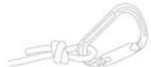
Рисунок 6. Баррел (применяется только для крепления к карабину самостраховки)
