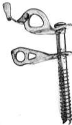
Рисунок 20. Использование ледобура с дополнительной проушиной для карабина
